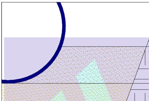
**FIGURA 25 Compactação adequada da área de “rins”**
