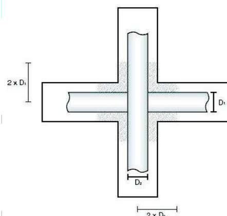
**FIGURA 16. Vista superior do reaterro primário dos tubos**
