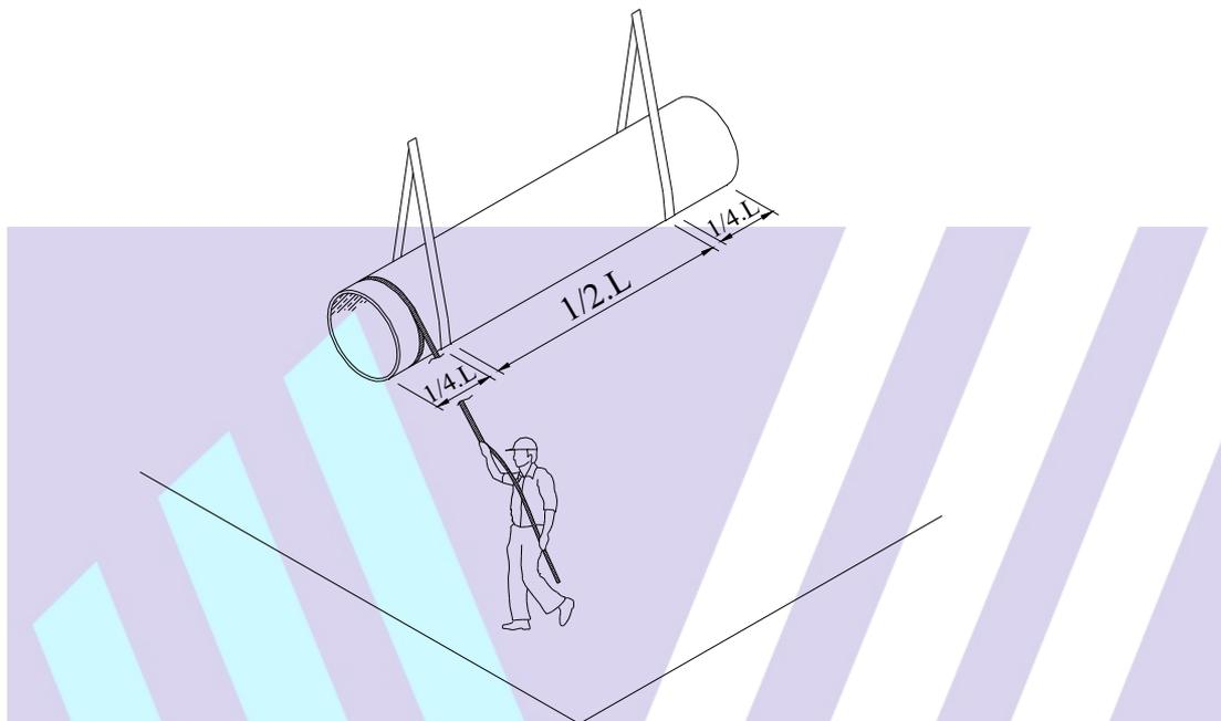
**FIGURA 20 Movimentação dos tubos através de cordas/cintas**
