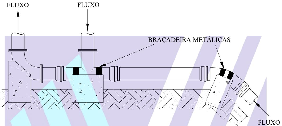
**FIGURA 28. Exemplo de bloco de ancoragem.**
