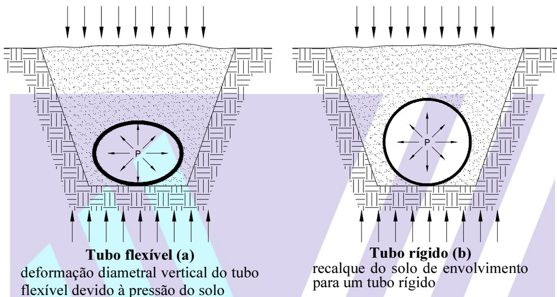
**FIGURA 1- Efeito do recalque de solo em um tubo flexível (a) e rígido (b).**
