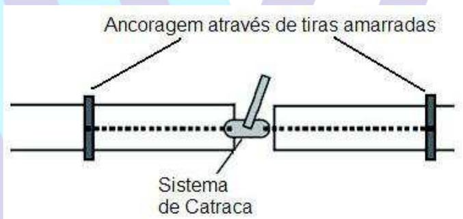
**FIGURA 22. Encaixe dos tubos por sistema de catraca.**
