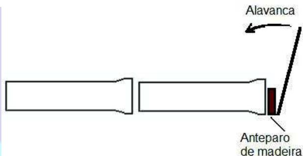
**FIGURA 21. Encaixe dos tubos por sistema manual (alavanca).**
