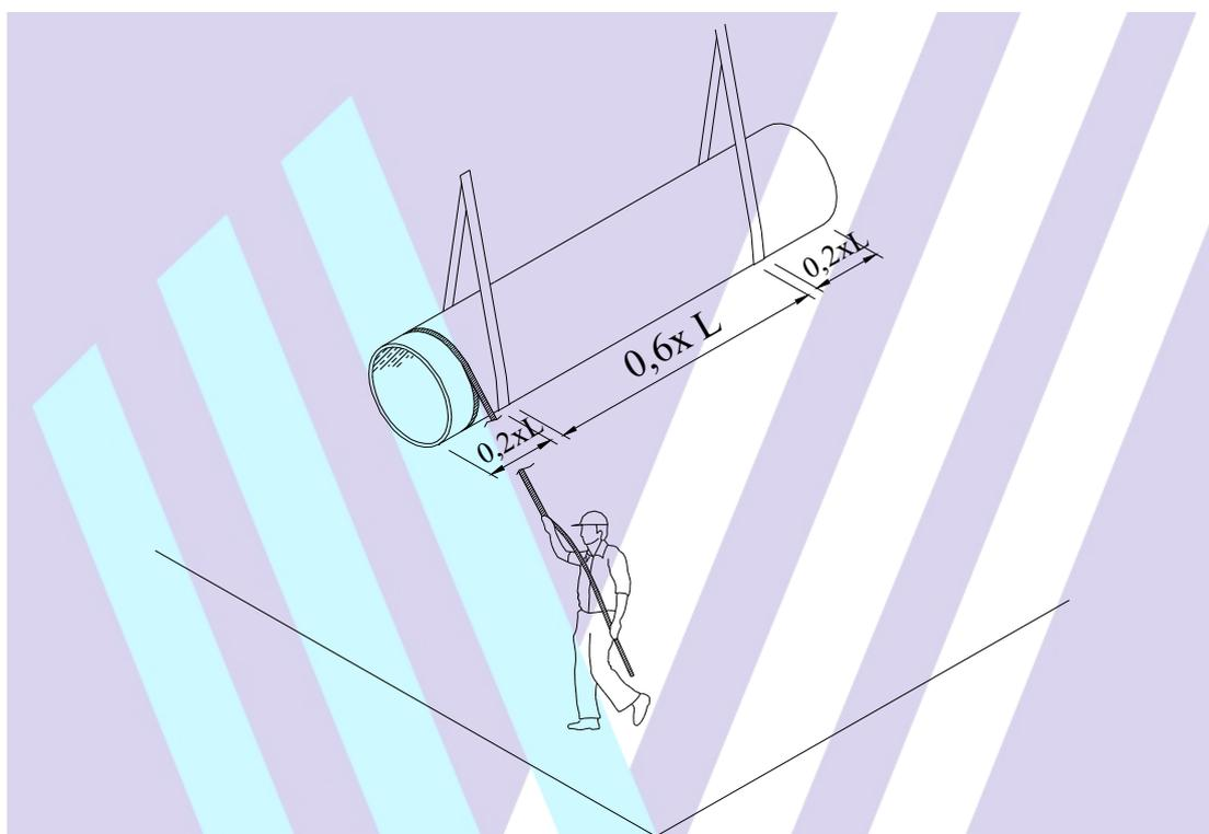
**FIGURA 30. Descarregamento unitário com dois pontos de apoio.**
