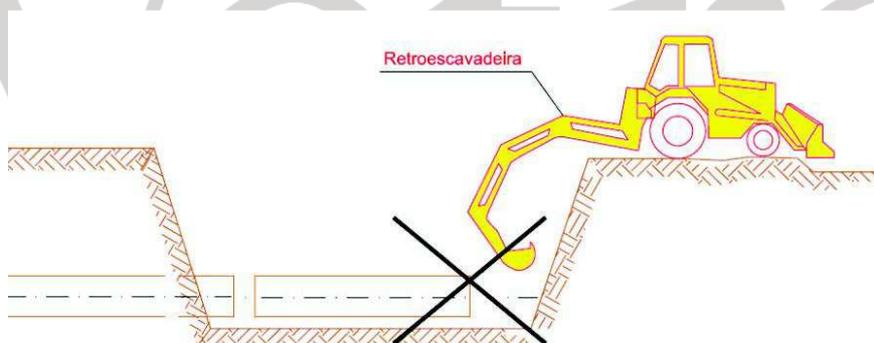
**FIGURA 23. Exemplificação de como NÃO deve ser realizado o encaixe dos tubos**
