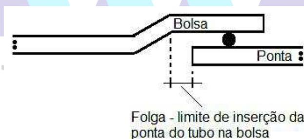
**Figura 20. Exemplificação do limite de inserção da ponta do tubo em uma bolsa, conforme recomendação do fabricante.**
